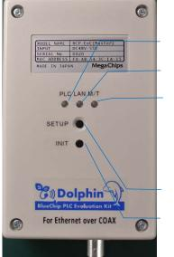
PLC LED : PLC Link status LAN LED : LAN status
