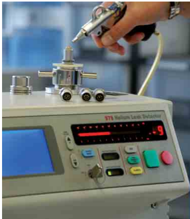
Vacuumtest with leakdetector Vakuumtest mit Leakdetektor
