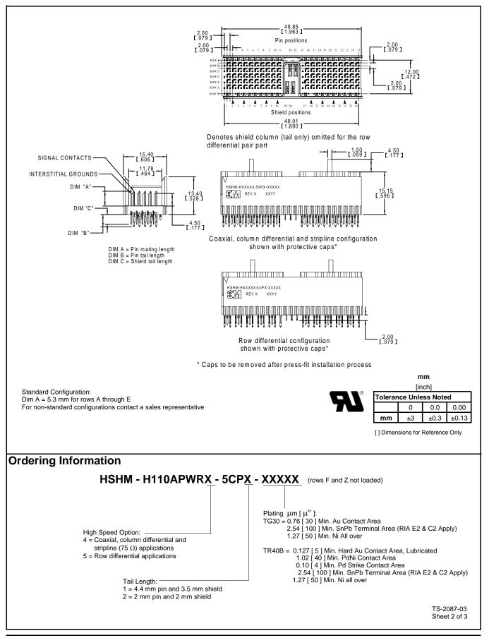
3M<sup>™</sup> MetPak<sup>™</sup> HSHM Press-Fit Power Header
